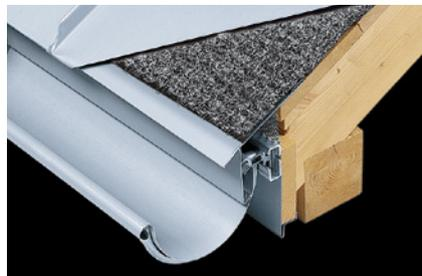
**Traufabschluss mit strukturierter Trennlage VAPOZINC (oder AIR-Z)**
